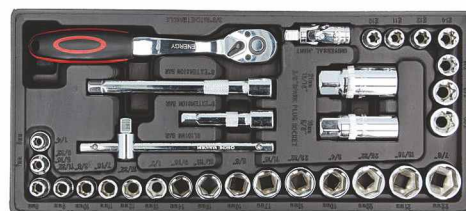
NE00200-3 Wkład 31 elementów: grzechotka 3/8" - przedłużka 3/8" dł 150 mm przedłużka 3/8" dł 80 mm-przegub 3/8" dł 60 mm -pokrętło 3/8" dł 170 mm -nasadki do świateł 3/8" 2x dł 70 mm : 16,21 - nasadki 3/8": 6,7,8,9,10,11,12,13,14,15,16,17,18,19,20,21,22, - nasadki 3/8" TORKS-E: E10,E11,E12,E14,E16,E18,E20
