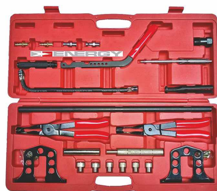
NE00331 Zestaw do demontażu uszczelek, sprężyn, prowadnic oraz tulei silnika, Do silników: 8, 16, 24 zaworowych.
