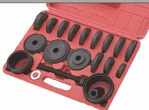
NE00099 Ściągacz łożysk piasty przedniej i tulei W zestawie: śruba -nasadki: 55,5, 59, 62, 65, 66, 71,5, 73, 78, 84, 86, 91 mm
