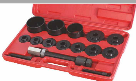
NE00006 / NE00160 Ściągacz do łożysk piasty przedniej Skład zestawu: -9 dysków: 55,5 mm, 59 mm, 62 mm, 65 mm, 66 mm, 71,5 mm, 73 mm, 78 mm, 84 mm, - 3 tuleje dystansowe: 76 mm, 86 mm, 91 mm -6 śruba Śruba napędowa 270 mm, nakrętka, podkładki, dystans. ( M12 x 1,5 mm oraz M14 x 1,5 mm)
