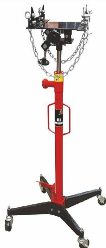
NE00419 Hydrauliczny podnośnik skrzyni biegów z adapterem max wysokość: 2050 mm, min wysokość: 1235 mm, Nośność: 300 kg, Waga: 45 kg
